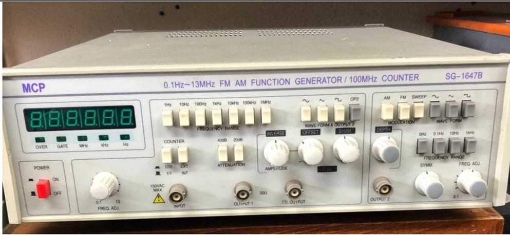
Generatore di funzioni (fino a 13 mhz) della MCP modello SG-1647B con frequenzimetro integrato fino a 100 mhz
