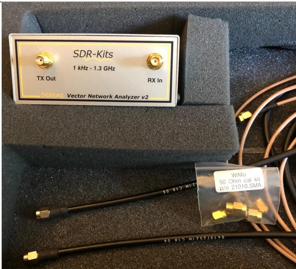
Vector Network Analyzer della SDR-kits operante tra 1khz- 1.3 ghz
