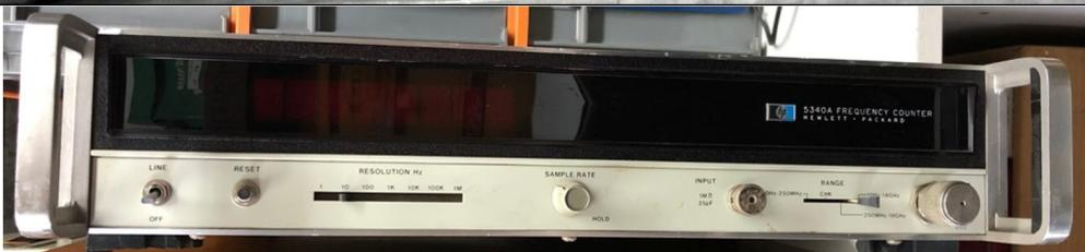
Frequenzimetro HP modello 5340A fino a 18 ghz
